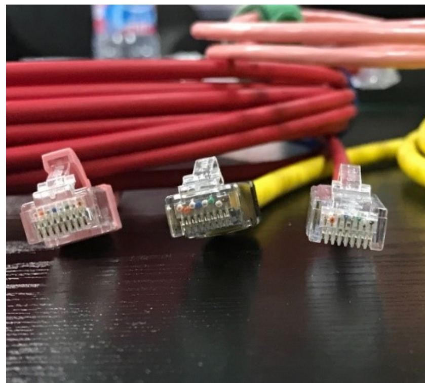
(b) 水晶头正视图时，间隔线芯从同一平面到上下相互错开或微距错开
