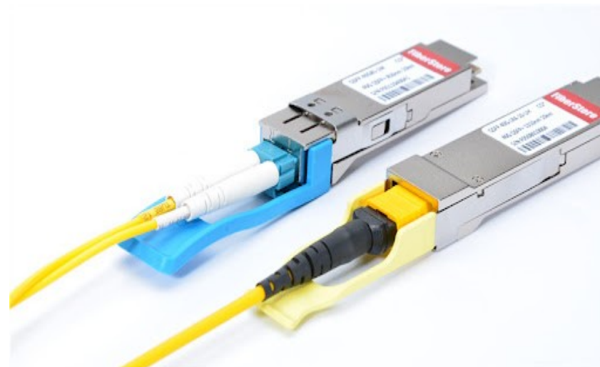
LC接头及模块（左）和MPO接头及模块（右）
