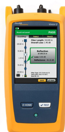
OptiFiber Pro光纤OTDR测试仪
